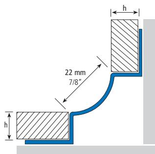
**ES** **EUROESCOCIA-210S**, perfil de Acero Inoxidable utilizado para el ensamblaje del encuentro pared-suelo. Compensa los movimientos horizontales y verticales existentes entre la pared y el suelo. Este perfil cumple con las normativas de higiene y limpieza requeridas en la industria alimentaria, establecimientos sanitarios, etc.
