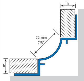
**ES** **EUROESCOCIA-210**, perfil de PVC utilizado para el ensamblaje del encuentro pared-suelo, así como para ángulos interiores entre paredes. Compensa los movimientos horizontales y verticales existentes entre la pared y el suelo. Este perfil cumple con las normativas de higiene y limpieza requeridas en la industria alimentaria, establecimientos sanitarios, etc.
