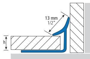
**ES** **EUROESCOCIA-191**, perfil de PVC utilizado principalmente para los ángulos interiores de paredes. No obstante también puede utilizarse para el ensamblaje del encuentro pared-suelo, en el cual se aconseja sólo la utilización de la gama de colores.
