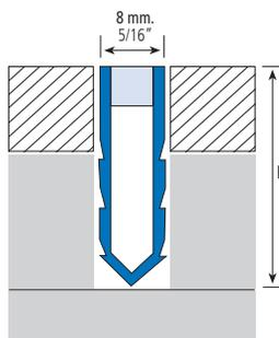
**ES EUROJUNTA-186**, junta de dilatación compuesta por dos partes: una rígida y otra flexible. Utilizada en el montaje con pavimentos, baldosas, piedra natural, etc. La función de este producto es compensar los esfuerzos de presión impidiendo la rotura del pavimento, gracias a su parte central flexible.
