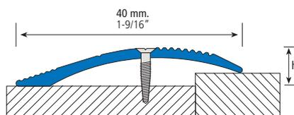
**ES EUROTRANSICIÓN-218A**, perfil de aluminio para transiciones entre pavimentos, que permite vencer desniveles desde 0 hasta 15 mm, permitiendo la transición entre cualquier tipo de pavimento.
