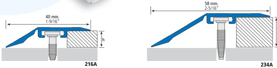
**ES EUROTRANSICIÓN-216A y 234A**, perfiles de aluminio para transiciones entre pavimentos, que permiten vencer desniveles desde 4 hasta 12 mm (216A) o desde 8 hasta 20 mm (234A), permitiendo la transición entre cualquier tipo de pavimento.
