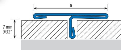
**ES EUROTRANSICIÓN-232S**, perfil de acero inoxidable en forma de T para transiciones entre pavimentos al mismo nivel o con desniveles mínimos. Se coloca entre ambos pavimentos con silicona que actúa como junta de dilatación, pues absorbe los movimientos de los mismos, y proporciona protección a los cantos del pavimento, cerámica o parquet, que de otra manera quedarían desprotegidos completamente.
