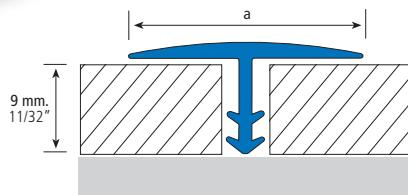
**ES** **EUROTRANSICIÓN-232A**, perfil de aluminio en forma de T para transiciones entre pavimentos al mismo nivel o con desniveles mínimos. Se coloca entre ambos pavimentos con silicona que actua como junta de dilatación, pues absorbe los movimientos de los mismos, y proporciona protección a los cantos del pavimento, cerámica o parquet, que de otra manera quedarían desprotegidos completamente.
