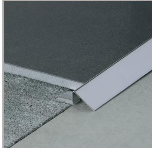
**ES** **EUROTRANSICIÓN-201S**, perfil de acero inoxidable diseñado para rematar la transición entre diferentes pavimento. Permite vencer desniveles producidos entre diferentes materiales, como por ejemplo en las reformas al colocar un nuevo pavimento sobre el original. Apropiado para todo tipo de material como moqueta, parquet, cerámica, vinilo..., así como para zonas de mucho tránsito por su resistencia.
