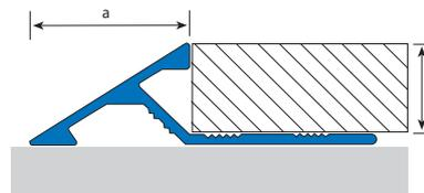
**ES EUROTRANSICIÓN-201A**, perfil de aluminio diseñado para rematar la transición entre diferentes pavimento. Permite vencer desniveles producidos entre diferentes materiales, como por ejemplo los producidos en las reformas al colocar un nuevo pavimento sobre el original. Apropiado para todo tipo de material como moqueta, parquet, cerámica, vinilo..., así como para zonas de mucho tránsito por su resistencia.
