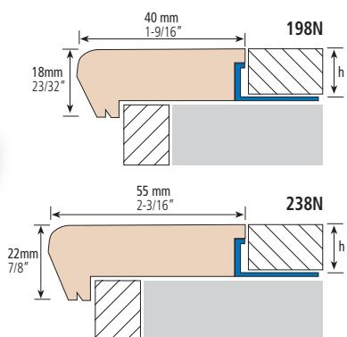
**ES** **EUROPELDAÑO-198/238N**, perfil para el remate de escalones, fabricado con dos componentes de gran calidad: madera y aluminio. La parte vista de 40 o 55 mm está fabricada en IROKO, que es una madera tropical de gran resistencia muy apropiada para uso en pavimentos. El aluminio es el componente del perfil mediante el cual se realiza la sujeción a la obra, proporcionando dureza y fiabilidad a largo plazo por su gran resistencia.
