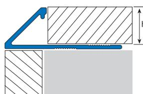
**ES EUROCANTO-145A**, Eurocanto de aluminio anodizado destinado a esquinas exteriores, alicatados a media altura o repisas, en revestimientos cerámicos. Su principal función es proteger los cantos del azulejo de los deterioros debidos a esfuerzos mecánicos. Con el EUROCANTO-145A, se obtiene un innovador acabado con ángulo de 45°, que rompe con los standards del momento.
