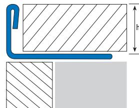
**ES** **EUROCANTO-183S**, perfil de acero inoxidable destinado a esquinas exteriores en revestimientos cerámicos. Su principal función es proteger los cantos del azulejo del deterioro debido a esfuerzos mecánicos. No obstante puede destinarse a otros usos: enmarcación de elementos decorativos, separador de ambientes, remate de escalones, etc. El EUROCANTO-183S ofrece múltiples posibilidades de combinaciones con todo tipo de cerámica o pavimento.
