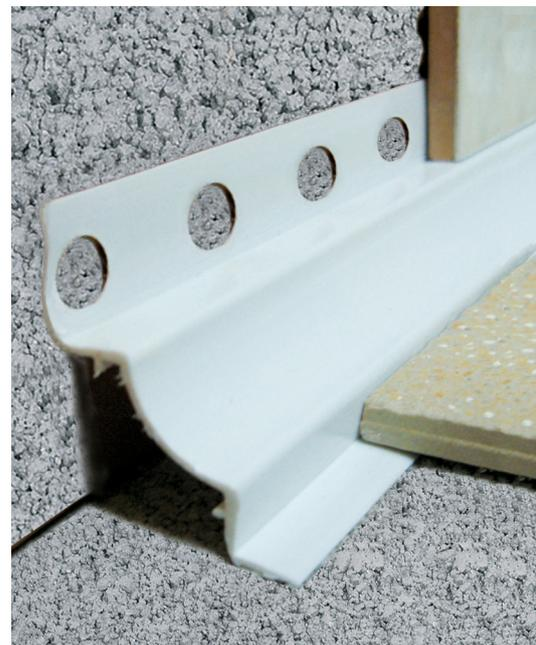
**ES EUROESCOCIA-210**, perfil de PVC utilizado para el ensamblaje del encuentro pared-suelo, así como para ángulos interiores entre paredes. Compensa los movimientos horizontales y verticales existentes entre la pared y el suelo. Este perfil cumple con las normativas de higiene y limpieza requeridas en la industria alimentaria, establecimientos sanitarios, etc.
