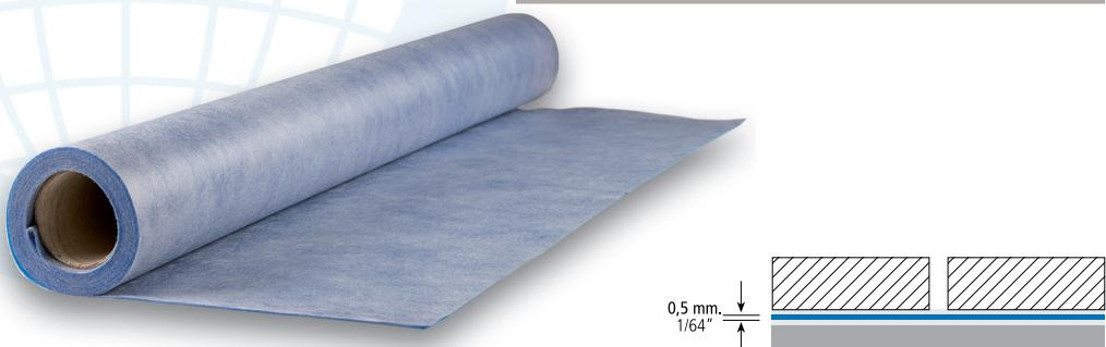
**E - EUROLAMINA IMPERMEABLE**, Lámina impermeable flexible de polietileno recubierta por una tela no tejida de fibras sintéticas, que garantiza el agarre total de la lámina en su colocación con cemento cola C2. Recomendada su colocación, junto con revestimiento o pavimento, para la impermeabilización de balcones y zonas húmedas interiores.
