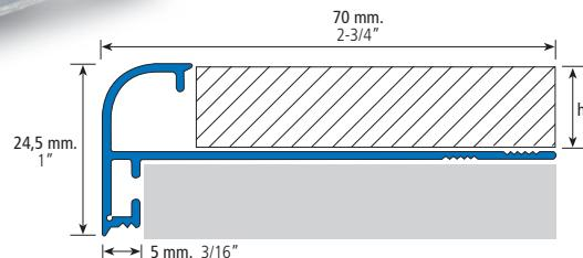
**ES** **EUROVIERTEAGUAS-242A**, perfil de aluminio de canto redondeado destinado a la protección de la cerámica en balcones o repisas exteriores. Colocado durante la obra proporciona el remate perfecto para evitar el goteo sobre la superficie vertical, evitando manchas antiespéticas en las paredes.
